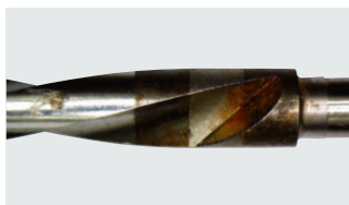
Fresa a spirale multipla Corrosione
