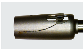
Prolunga per fresa Corrosione, frattura
