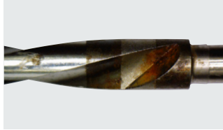
Spiralbohrer – Mehrfach Korrosion
