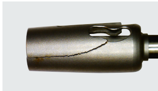
Bohrer verlängerer Korrosion, Brüche
