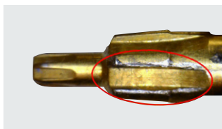
Implantateindreher Schlechte Passung Verschleiß der TiN-Beschichtung Verformung durch zu Hohes Drehmoment
