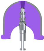
9. Das Modellimplantat wird mit Hilfe des Neo Schraubendrehers auf dem Abformpfosten befestigt. Während Sie die Schraube mit dem Schraubendreher stabilisieren, überprüfen Sie die korrekte Platzierung und ziehen Sie das Modellimplantat manuell an – NICHT ÜBERDREHEN (maximal 10 Ncm).
