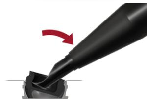
12. Posizionare la cappetta finale sulla punta dello strumento Equator, sul lato di inserimento, e spingere in modo deciso nell'alloggiamento metallico.
