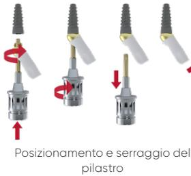
4. Il serraggio finale della vite del pilastro a 32 Ncm viene effettuato utilizzando la chiave dinamometrica e il cacciavite Neo.
