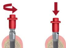
3. Inserire il transfer per impronta a livello dell'impianto della lunghezza desiderata (8, 11 o 18 mm) (11 mm per impianto Ø3.25 mm) e stringere la vite con il cacciavite Neo e il manipolo manuale.
